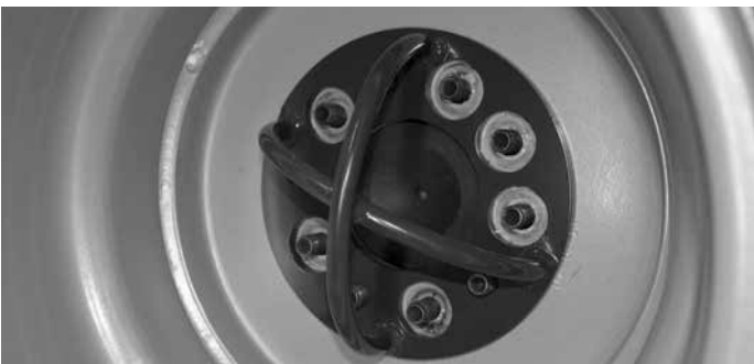
Sidontakiinnike pyörän napaan A423091
