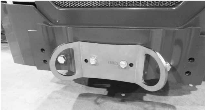
Sidontakiinnike A418623 asennettuna takapuskuriin tai takapainoon
